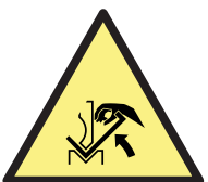
Pericolo schiacciamento mani tra la pressa e il materiale 158 K
