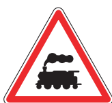
Figura 9 passaggio a livello senza barriere
