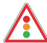
Figura 31/a semaforo con lanterne verticali
