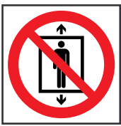
Vietato l'uso di questo ascensore alle persone 213 KXY ●
