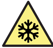
Pericolo bassa temperatura condizioni di congelamento 134 K
