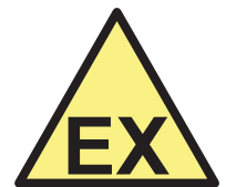
Pericolo esplosione 146 KW
