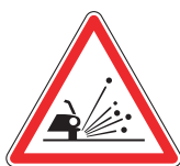
Figura 29 materiale instabile sulla strada
