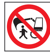
Vietato fermarsi/passare nel raggio dell'escavatore 217 KXY
