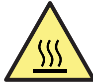
Pericolo superficie calda 129 KX
