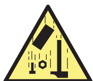
Pericolo caduta materiali
