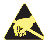
Pericolo cariche elettrostatiche 145 KW
